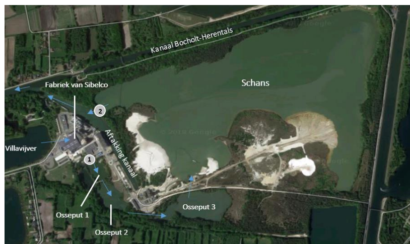
Figuur 17. Satellietbeeld van de beschikbare ruimte op de Sibelco-site te Dessel-Mol. De blauwe pijlen illustreren de waterstroom. Locatie 1 stelt de locatie van de koelwaterlozing voor. Locatie 2 toont de overloop waar het water van de Schans in het kanaal terechtkomt
